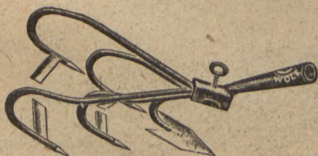
Rys. 7. Motyki pazurkowe Wolfa. Pazurki są zaopatrzone w nożyki, których zadaniem jest wycinanie chwastów.
