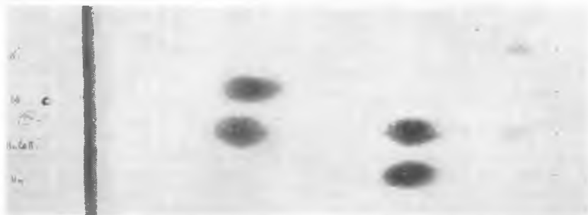
Ryc. 1. Rozdział niklu, manganu i kobaltu metodą chromatografii bibułowej wstępującej; wywoływacz — odczynnik I, rozpuszczalnik — aceton : 5,5 n HCl w stosunku objętościowym 85:15
