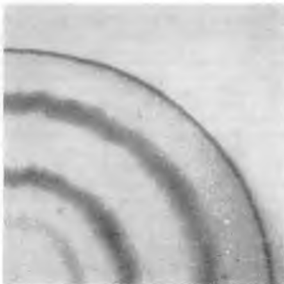
Ryc. 2. Rozdział niklu, manganu i kobaltu — chromatogram krążkowy; wywoływacz — odczynnik I, rozpuszczalnik — aceton : 5,5 n HCl w stosunku objętościowym 85:15
