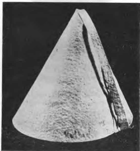
Ryc. 29. Miedź zagęszczona na końcu paseczka. Układ kolidyna : 0,4 n kwas azotowy, (1 : 1).
