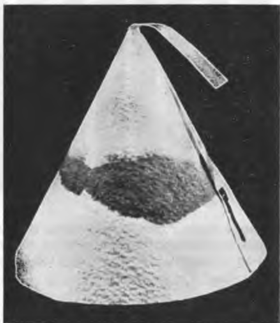
Ryc. 30. Rozdzielenie śladów miedzi od ołowiu. Miedź na pasku, ołów na stożku.
