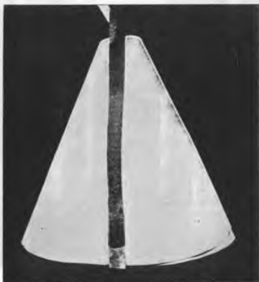
Ryc. 26. Miedź zagęszczona metodą stożkową.
