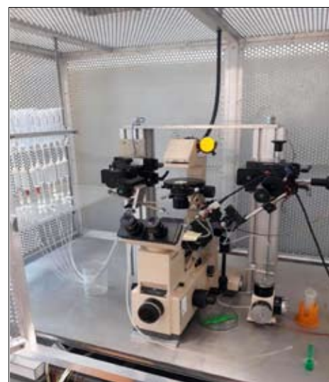
Rys. 4. Jedno ze stanowisk do pomiarów elektrofizjologicznych techniką „patch-clamp”, znajdujące się w Katedrze Biofizyki i Neurobiologii Uniwersytetu Medycznego we Wrocławiu. Na tym stanowisko Autor niniejszego artykułu badał wpływ wybranych statyn na aktywność kanałów typu Kv1.3 w komórkach nowotworowych – Jurkat T.
