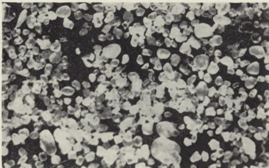
Ryc. 7. U góry — piaski plażowe Bałtyku z Jarosławca. Ziarna piasku różnej wielkości z przewagą ziarn częściowo obtoczonych i obtoczonych. U dołu — piaski plażowe Morza Czarnego z miejscowości Primorsko. Większe okruchy muszli mięczaków na tle drobnych, częściowo obtoczonych ziarn kwarcu
