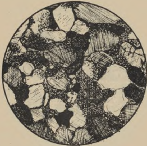
Ryc. 6. Kwarc z obwódkami re- generacyjnymi wśród spoiwa opałowego (ok. x 40) Quartz with secondary outgrowths in opal matrix
