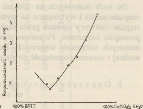
Ryc. 10b. Krzywa zależności rozpuszczalności osadu \text{Co}(\text{BPTT})_2 od składu roztworu
